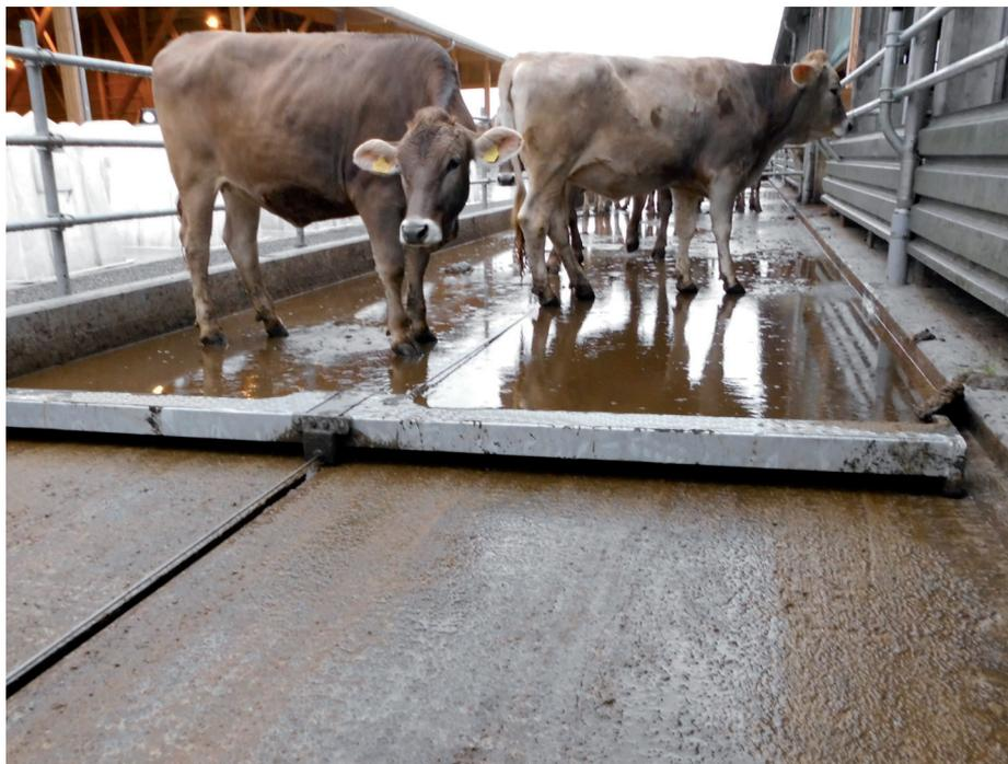
Der Breitschieber ermöglicht durch seine geringe Bauhöhe von 15 cm ein leichtes Übersteigen der Tiere. Durch das Gelenk in der Mitte passt sich der Schieber dem Gefälle an. Optimale Boden Anpassung dank Einzelklappen, diese sind mit Bürstenprofil oder einer Verschleissplatte ausgerüstet.
